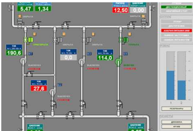
Рис. 1. Визуализация в SCADA системы работы насосной станции
