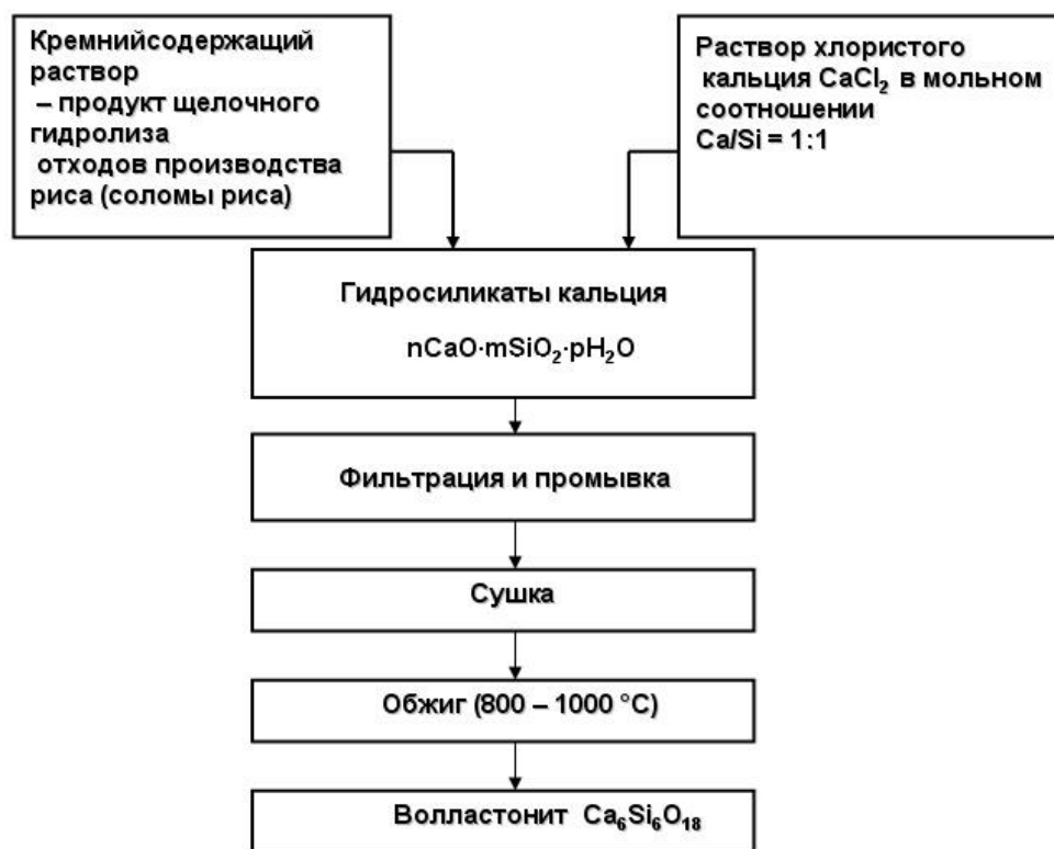
Рис. 1. Принципиальная технологическая схема получения силикатов кальция из щелочных экстрактов соломы риса
