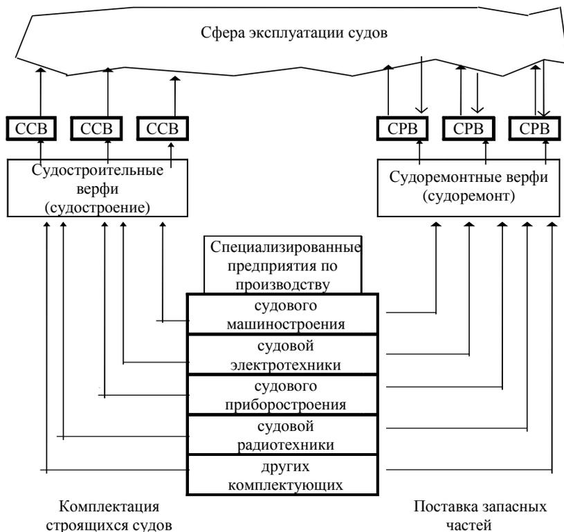
Рис. 4.1. Схема предлагаемого производственного судостроительно-судоремонтного комплекса
