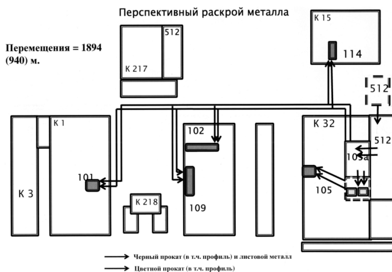
Рисунок 6 – Планируемая к 2015 (2020) гг. схема организации расположения участков, складов и перемещений материалов и заготовок
