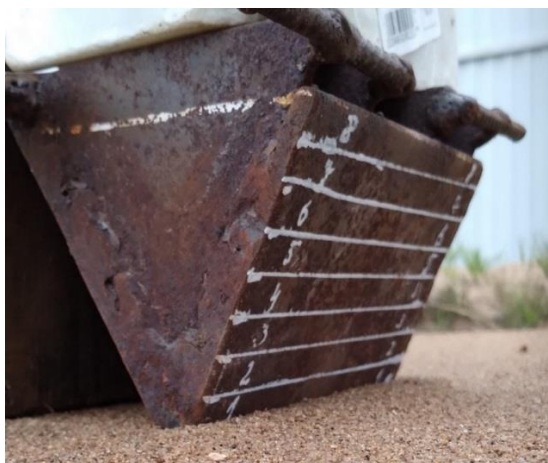
Рис. 7. Пример статического вдавливания клина
