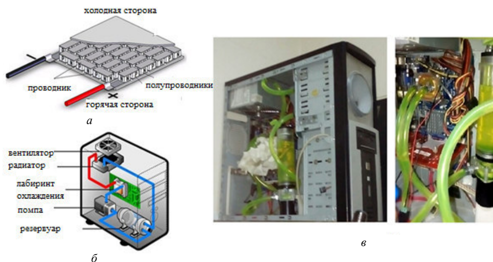
Рис. 1. Система охлаждения на базе Пельтье: а – элемент Пельтье; б – контур системы СЖО; в – система прототипа
