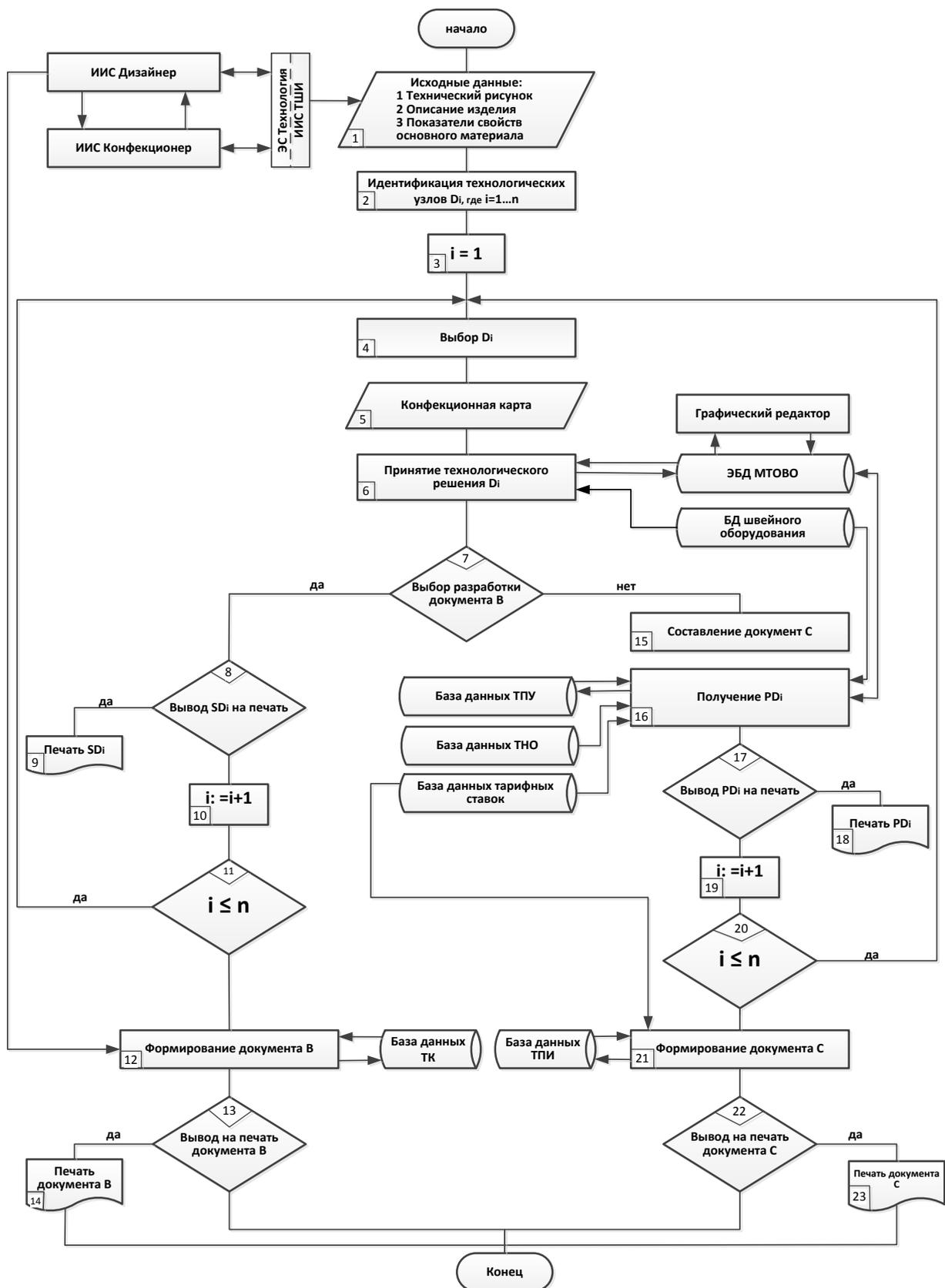
Рисунок 2 – Блок–схема алгоритма функционирования информационной интеллектуальной системы ТШИ на этапе принятия технологических решений
