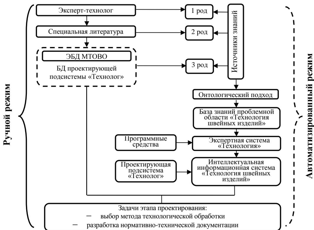
Рисунок 1 – Сравнительная схема маршрутов принятия технологических решений в ручном и автоматизированном режимах
