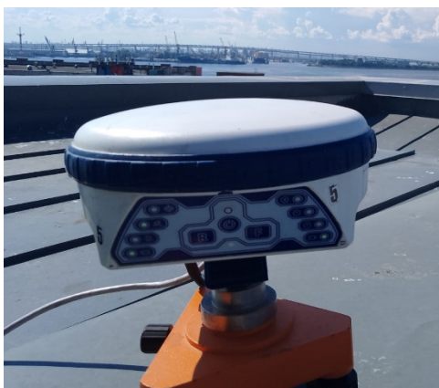
Рис. 28. «Аппаратура ПС» в процессе установки на Контрольной точке (фото авторов)
