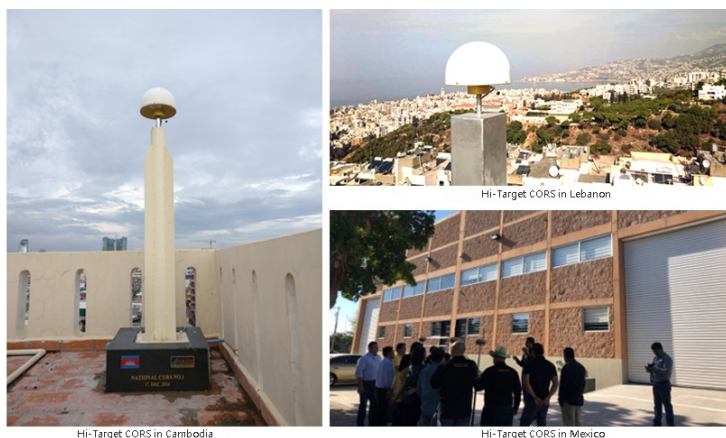
Рис. 3. Наземные опорные станции Hi-Target CORS, установленные в Камбодже (слева), Ливане (справаверху) и Мехико [2]
