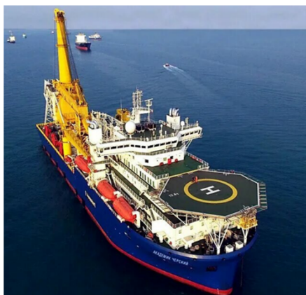
Рис. 5. Краново-монтажное трубоукладочное судно «Академик Черский» (фото с ресурса fleetphoto.ru)
