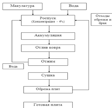
Рисунок 2 – Технологическая схема производства волокнистых плит [11]
