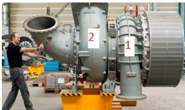
Рисунок 1 – Общий вид турбокомпрессора 1 – компрессорная часть; 2 – турбинная часть
