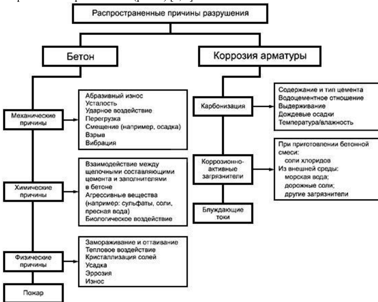
Рисунок 1 – Распространённые причины разрушения железобетона
