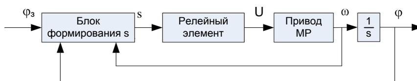
**Рис 1.** Типовая структурная схема релейной системы управления приводом МР
