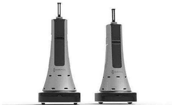
Рис. 3. Робота-мерчандайзер с RFID-считывателями
