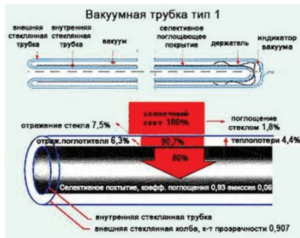
Рис. 10. Конструкция и схема распределения потерь в трубке коллектора
