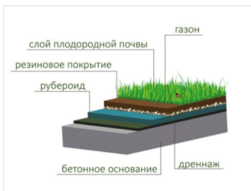
Рис. 1. Система укладки газона на кровлю.
