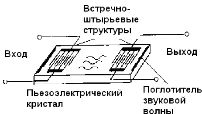
Рис. 25. Линия задержки на основе ПАВ
