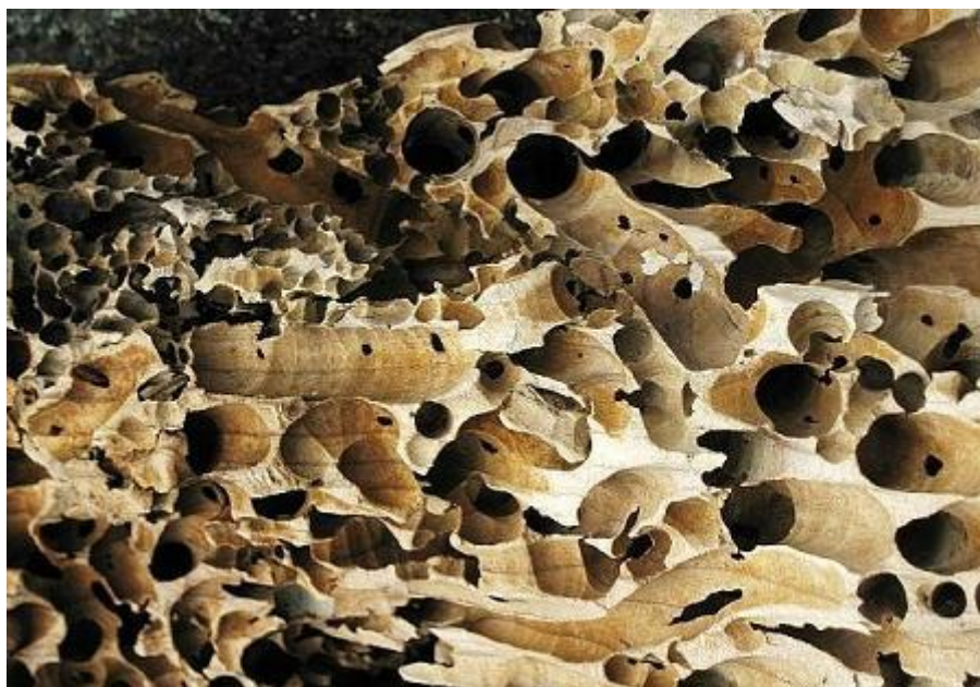
Рис. 4. Структура поражённой древоточцами древесины
