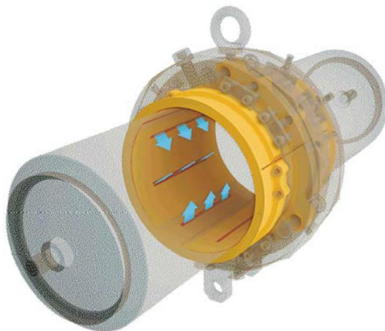
Рис. 1. Схема газостатических подшипников [3]
