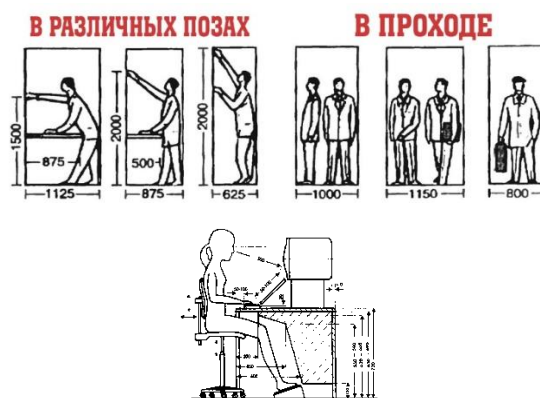
Рис. 12. Нормы эргономики для организации проемов, проходов и рабочих мест
