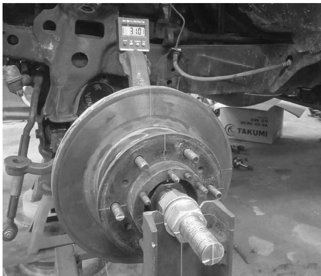
Рис. 12. Стапель для поворотного кулака
