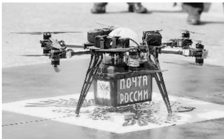
Рис. 3. Дрон-курьер, оснащённый отсеком для посылки
