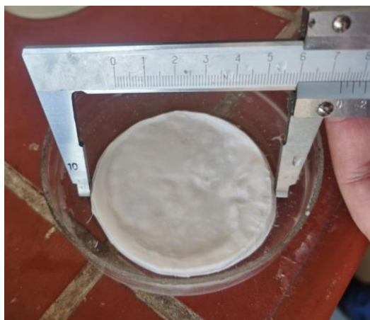
Рисунок 4 - Контроль усадки образца (начальный размер – диаметр чашки Петри, размер образца с течением времени контролировался штангенциркулем по характерным диаметрам).
