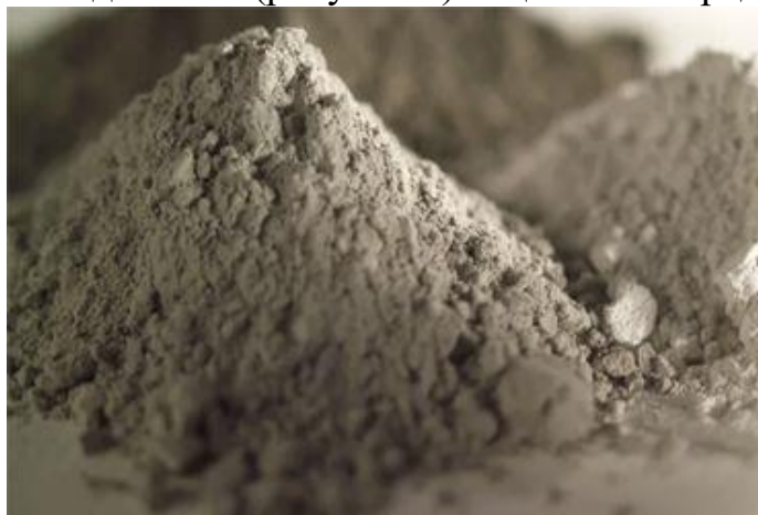
Рисунок 3. Алюмосиликатное вяжущее, полученное из ЗШО ТЭС
