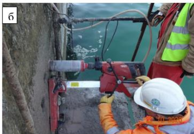
Рисунок 2 – Процесс отбор кернов: а) горизонтальный участок; б) вертикальный участок- зона действия прилива, для лабораторных исследований
