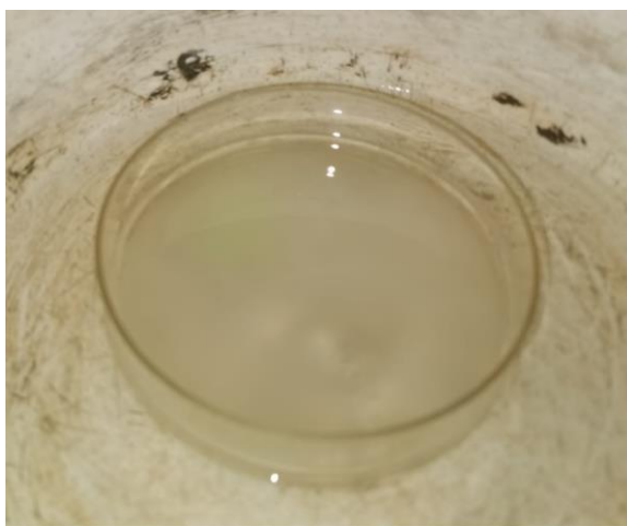
Рисунок 3 - Образование гелевой структуры образца ПВХ-ДФМА
