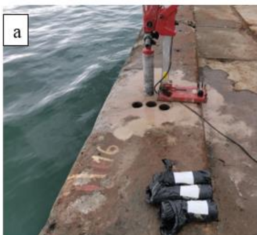
Рисунок 2 – Процесс отбор кернов: а) горизонтальный участок; б) вертикальный участок- зона действия прилива, для лабораторных исследований
