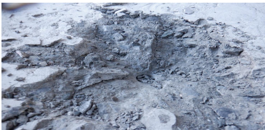
Рис. 6. - Результат испытания анкера (конус вырыва)
