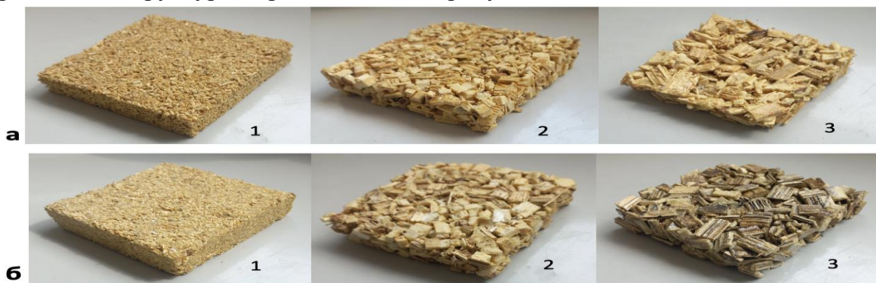
Рисунок 1 – Внешний вид образцов: а – на основе модифицированного БС; б – на основе не модифицированного БС (1 – размер частиц БС 1 мм; 2 – 5 мм; 3 – 10 мм.) [12]
