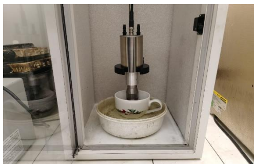
Рисунок 2 - Схема лабораторной установки (ультразвуковая мешалка, керамическая чаша-реактор, чаша-кристаллизатор с водой, шумозащитный кожух).
