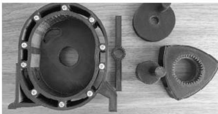
Рис. 2. Все распечатанные детали роторного двигателя Ванкеля
