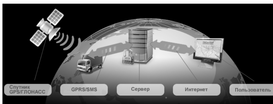
Рис. 1. Базовая схема реализации системы мониторинга
