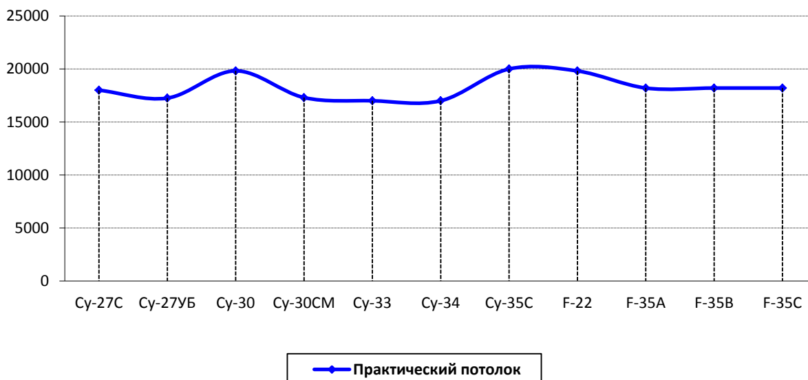
Рис. 5. Сравнение ЛА по параметру практического потолка
