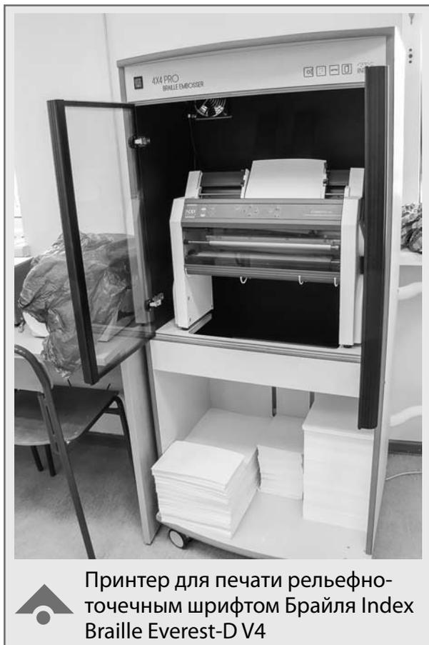
Принтер для печати рельефно-точечным шрифтом Брайля Index Braille Everest-D V4
