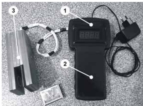
Рисунок 1. Общий вид ЭУК рН: 1 – блок индикации; 2 – автогенераторный измерительный преобразователь; 3 – первичный преобразователь
