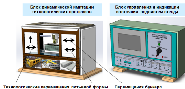
Рисунок 2 – Внешние виды функциональных блоков демонстрационно-тренажерного стенда «Плита-БЗ»
