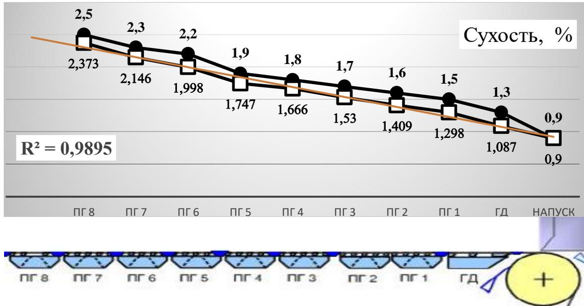
**Рис. 3. Обезвоживание на сеточном столе БДМ**
