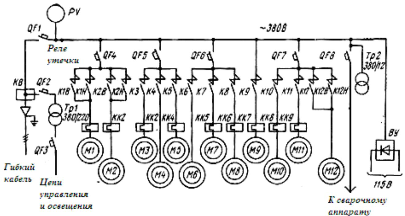
Рис. 2. Принципиальная схема питания электродвигателей шарошечного бурового станка типа СБШ-250-МНА32
