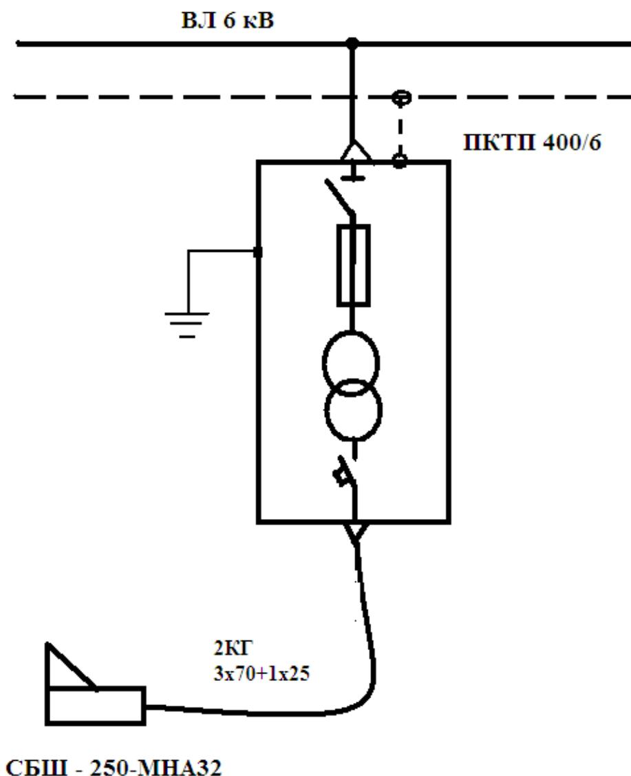
Рис. 1. Схема электрического питания бурового станка
