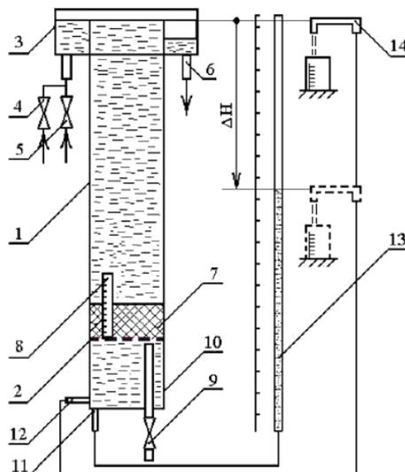
Рис. 1. Схема прибора ЛПИ для определения коэффициентов фильтрации бумажной массы: 1-цилиндр, 2-сетка, 3-переливной ящик, 4,5-краны водопровода, 6-трубопровод, 7-слой осевших волокон, 8-мерная шкала, 9-кран для отвода воздуха, 10-донная съемная часть, 11,12-штуцеры, 13-манометрическая трубка, 14-сливная трубка
