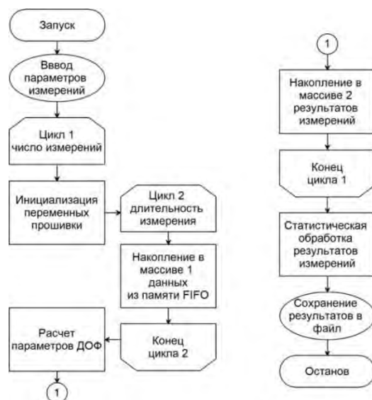
Рис.2. Блок-схема программного обеспечения
