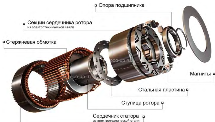
Рис. 1. Схема синхронного электродвигателя с постоянными магнитами
