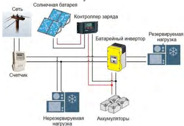
Схема 1. Структура фотоэлектрической системы в жилых домах
