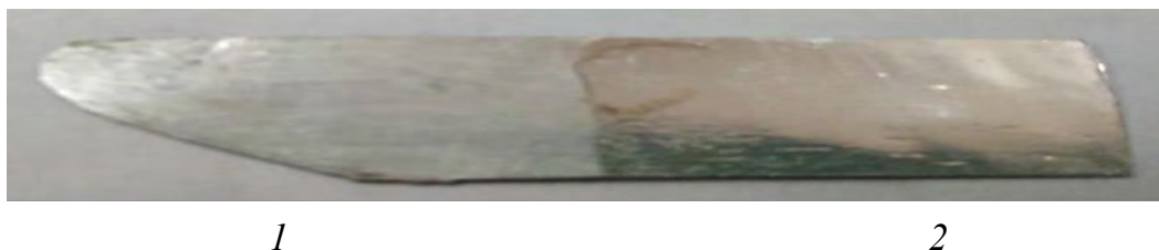
Рис. 4. АСМ изображение поверхность электрохимически полированного алюминия: а) 2D, б) 3D, в) внешний вид пластинки алюминия: 1- неполированная поверхность, 2 – зеркальная поверхность, подвергшаяся электрополировке
