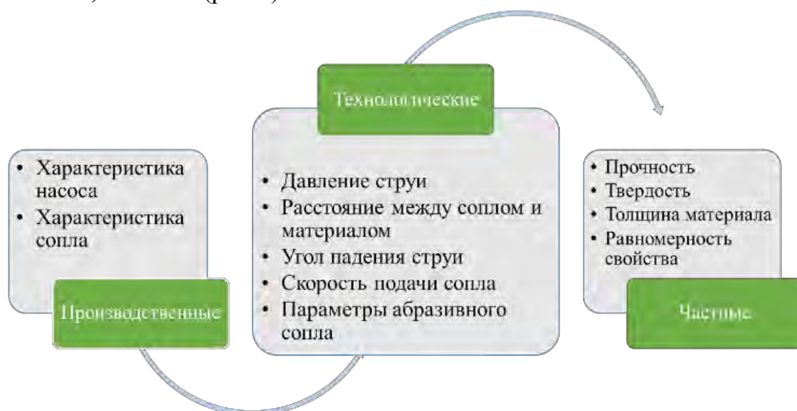
Рис.1. Взаимосвязь параметров технологической системы ГАР и факторов качества реза
