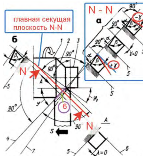
Рис. 1. Поверхности и плоскости при точении.
