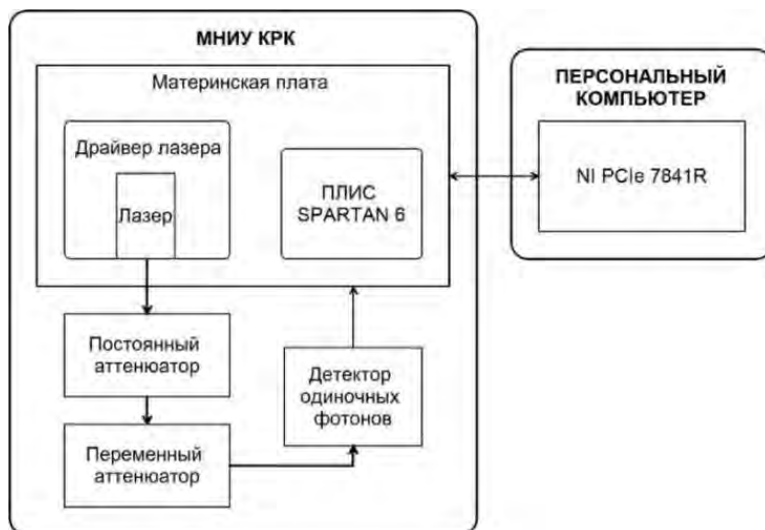
Рис.1. Структурная схема установки для измерения параметров ДОФ
