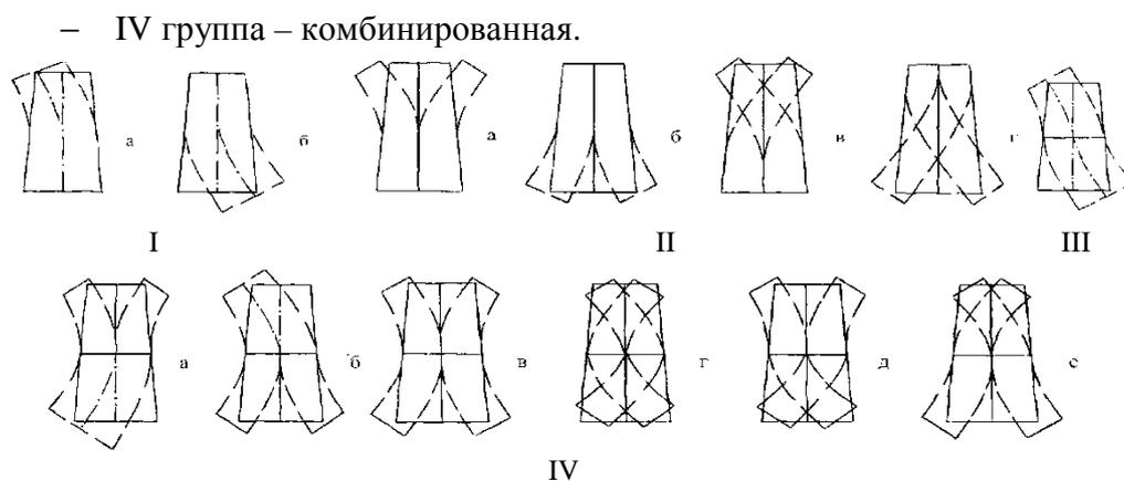
Рис. 1. Варианты схем разбивки и затягивания шкурок и их частей
