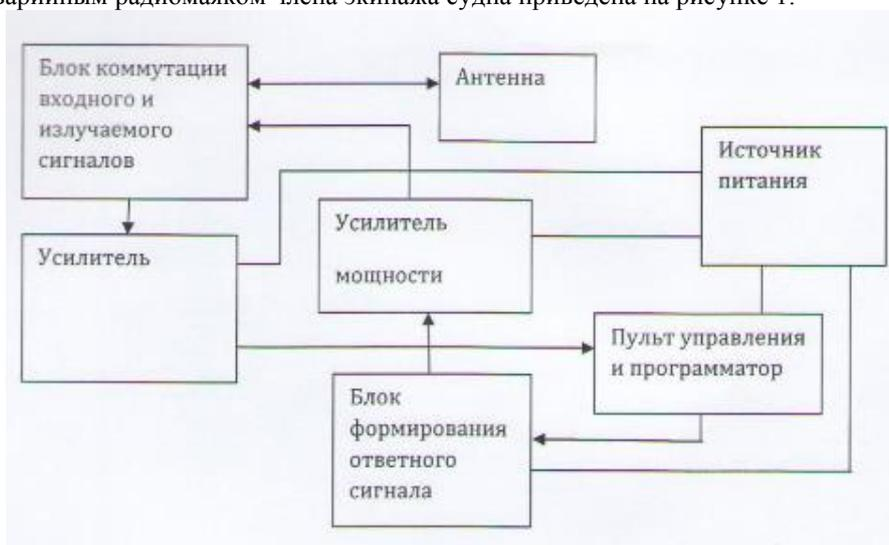
Рис. 1. Структурная схема радиоэлектронного устройства спасательного жилета
