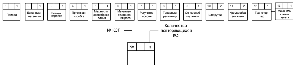
Рис. 1. Конструкторско-структурная схема ткацкого станка СТБ-180
