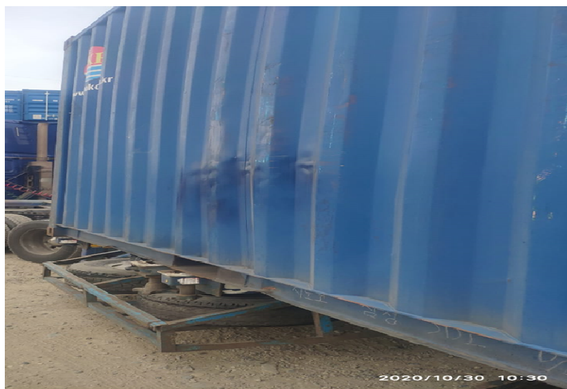
Рис. 3. Выгибание стен контейнера
