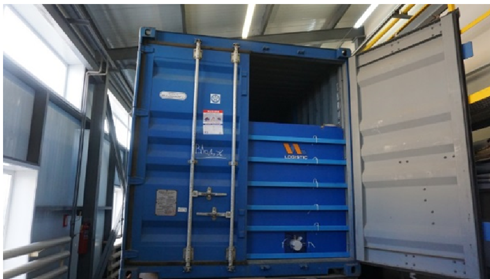
Рис. 2. Щит с защитными балками
