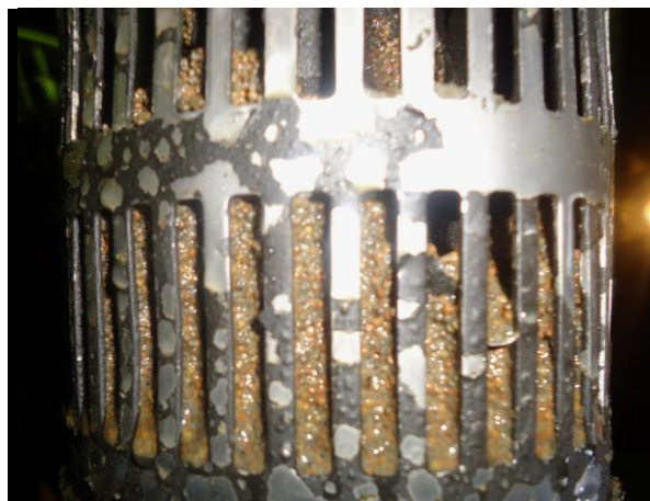
Рисунок 1. Засорение механическими примесями приемной сетки ЭЦН (пропант+песок)
