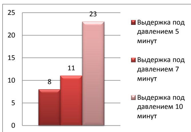
Рисунок 6. Влияние времени выдержки под давлением на прочность
