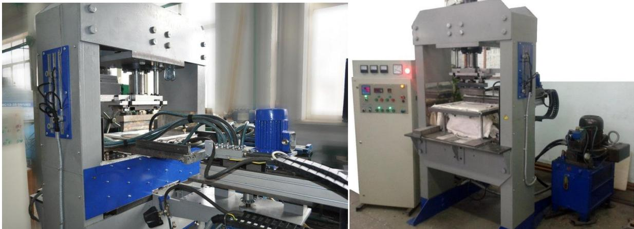
*Рис. 1. Технологический комплекс горячей листовой штамповки титановых сплавов*
