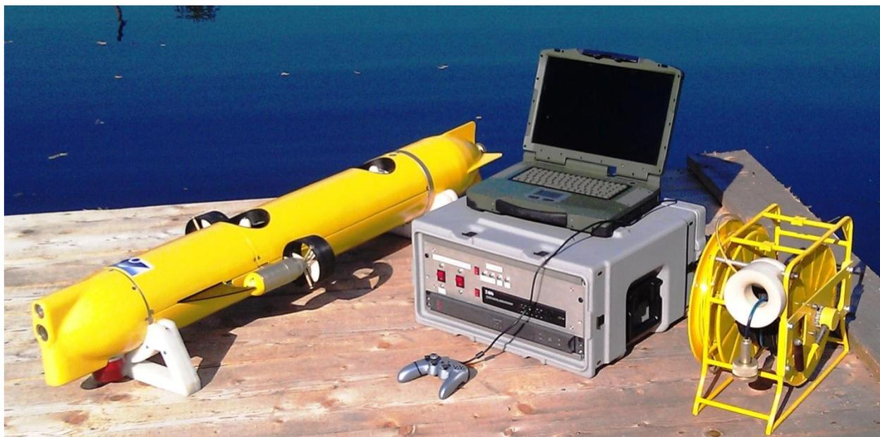
*Рис. 3.* Внешний вид малогабаритного необитаемого подводного аппарата с автономным питанием «Чилим»
