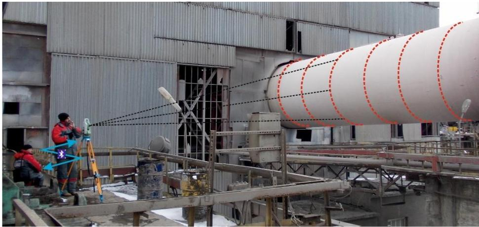
Рис. 2. Измерение сечений обечайки в кинематическом режиме
