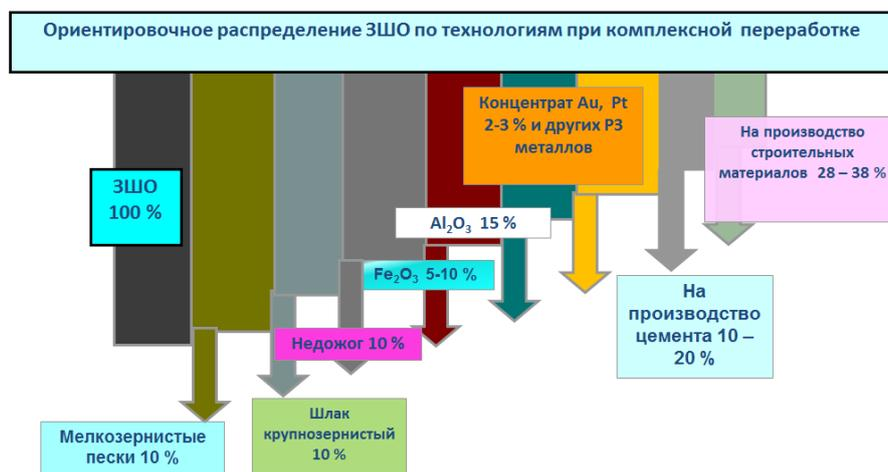
Рис. 1. Распределение ЗШО по технологиям при комплексной переработке
