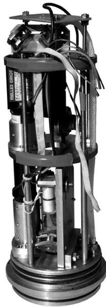
Рис. 1. Внутренний вид лазерного измерителя вариаций давления гидросферы
