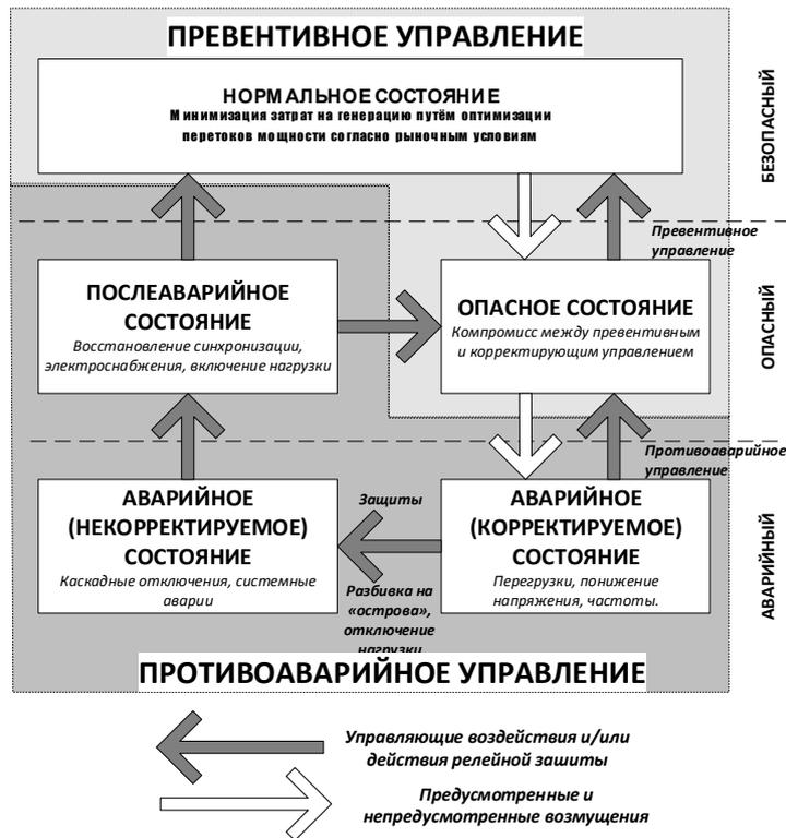
Рис. 1. Режимы работы (состояния) ЭЭС и их переходы в зависимости от возмущений
