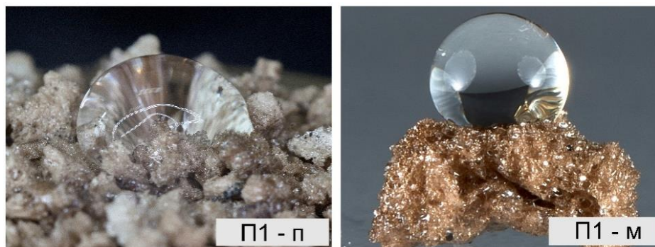
Рисунок 6 - Макросъёмка капли воды на образцах пеносиликата
