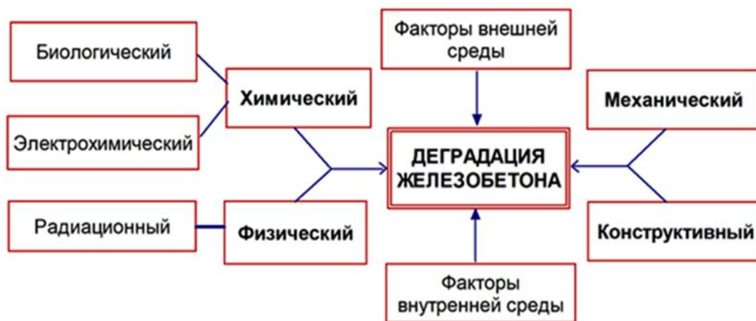
Рисунок 1 - Триада долговечности железобетона и виды коррозионных факторов
