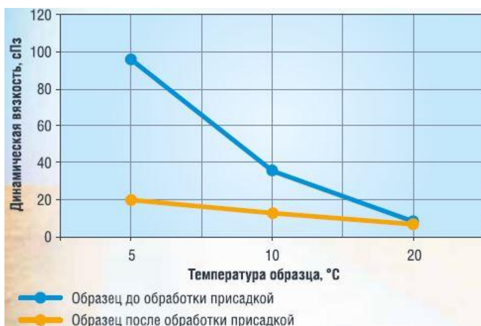
Рисунок 1 – Снижение вязкости нефти при применении депрессорных присадок [7]
