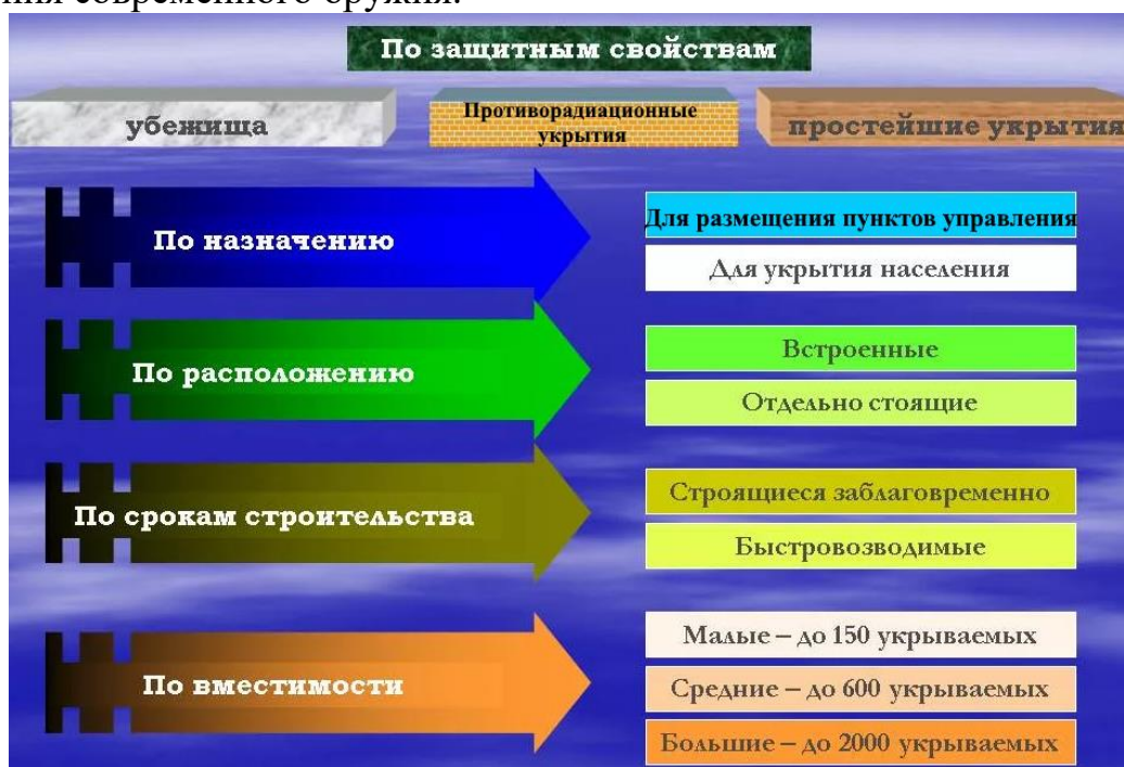
Рисунок 1 - Классификация защитных сооружений ГО [1, 2, 5-10]
