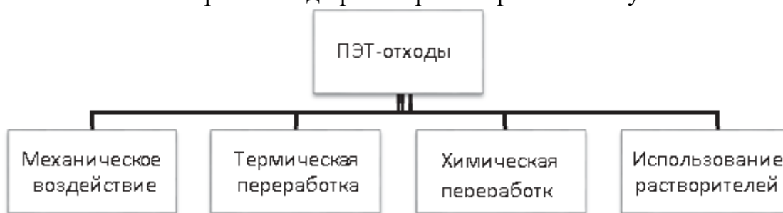
Рисунок 1 – Способы подготовки ПЭТ-отходов перед использованием для модификации битумов
