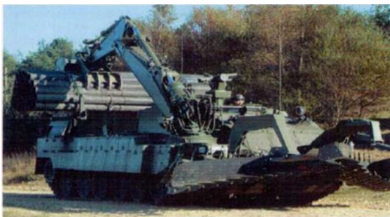
Рисунок 1 - Универсальная бронированная инженерная машина «Trojan» (Великобритания)
