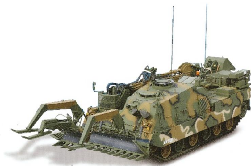
Рисунок 3 - Боевая инженерная машина К600 (Корея)
