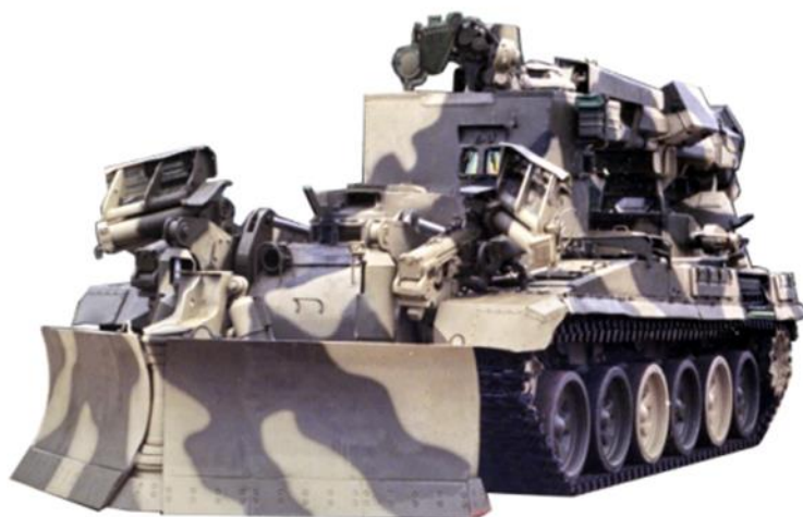
Рисунок 4 - Инженерная машина разграждения ИМР-3 (Россия)
