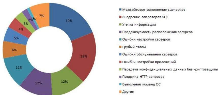
Рис. 3. Результаты исследования компании Positive Technologies за 2009 год об уязвимости приложений
