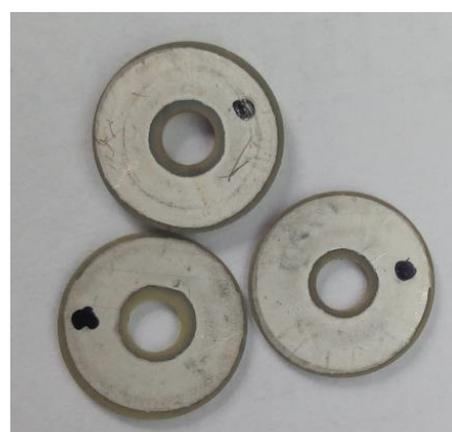
б) образцы пьезоэлементов №4,5,6
