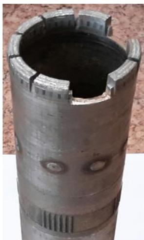
**Рис. 2 Опытная коронка КИТ: 1 – широкие промывочные каналы, полученные путем удаления двух алмазосодержащих секторов; 2 – наплавки для наблюдения за механизмом движения коронки при бурении**
