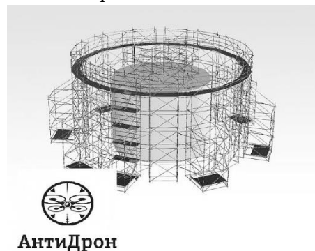
Рисунок 6. Используемая в зоне СВО внешняя защита РВС.
