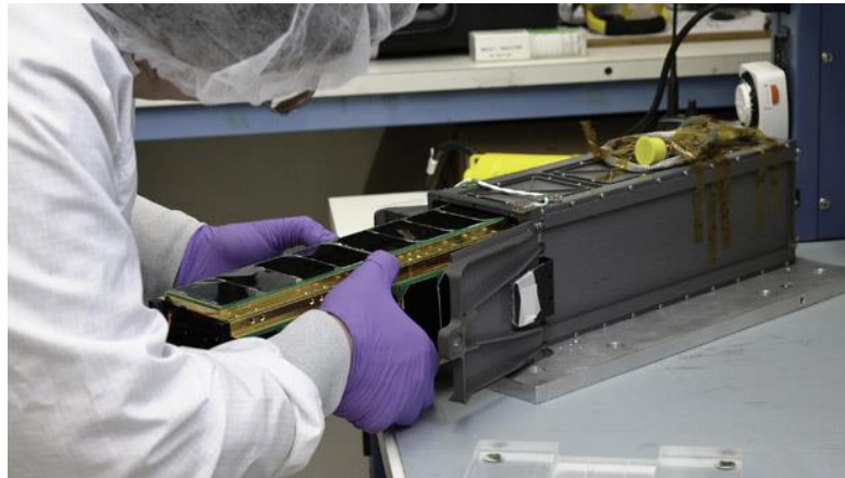
Рис. 6. Изображение ТПК Р-POD Mk. III Закрепленного на переходной плите в процессе установки МКА PW-Sat [5].
