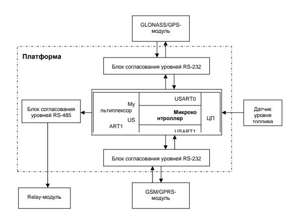
Рисунок 2. Функциональная схема лабораторного макета
