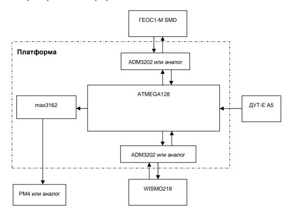
Рисунок 3. Структурная схема лабораторного макета
