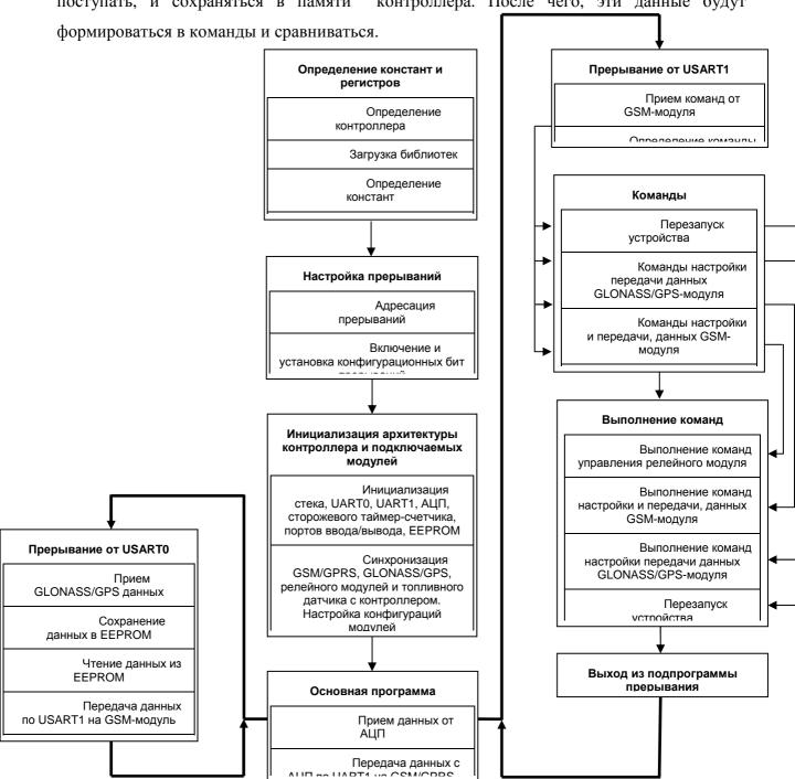
Рисунок 1. Алгоритм работы программного обеспечения микроконтроллера.
