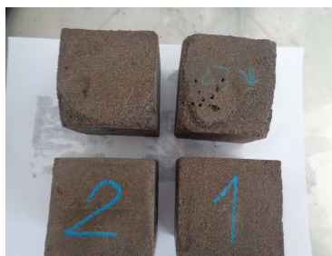
Рис. 7.6. Внешний вид образцов после испытаний на морозостойкость: без добавки волластонита (вверху) и с содержанием волластонита в количестве 3–3,5 масс. % (внизу)
