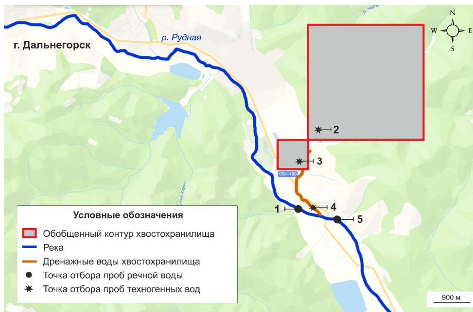
Рис. 4.2. Схематическая карта отбора проб в горнопромышленной системе «Бор»: 1 – пробы природных вод р. Рудной выше комплекса ХВ; 2 – шламовые воды каскада действующих ХВ; 3 – шламовые воды закрытого ХВ; 4 – дренажные воды комплекса ХВ; 5 – природные воды р. Рудной ниже комплекса ХВ
