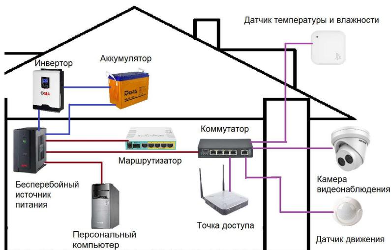
Рис. 3. Схема подключения электропитания
