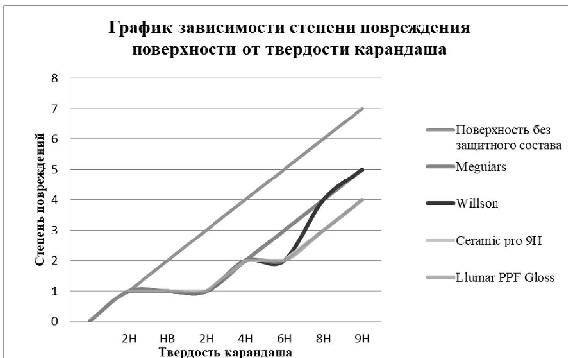
Рис. 2. Зависимость степени повреждения поверхности от твердости карандаша
