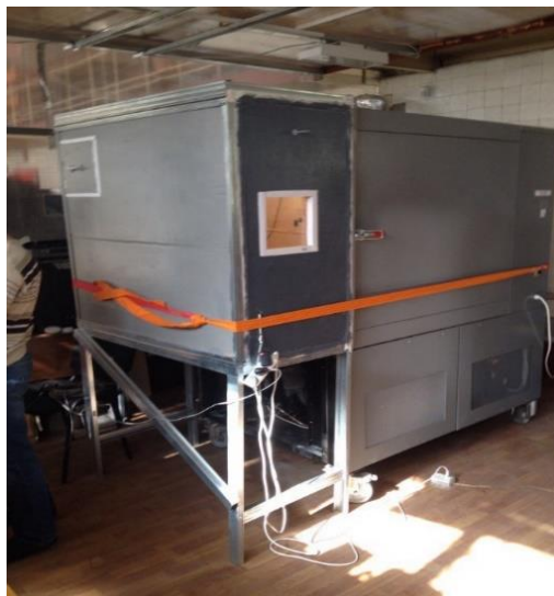
Рисунок 2. Образец СМЛ при измерении в климатической установке с холодильной камерой типа TX-500
