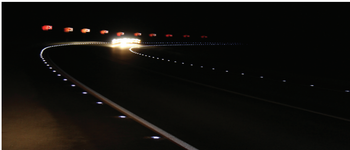
Рис. 2. Маячки обозначают направление движения — это актуально для сложных участков с изменениями продольного профиля дороги в темное время суток.
