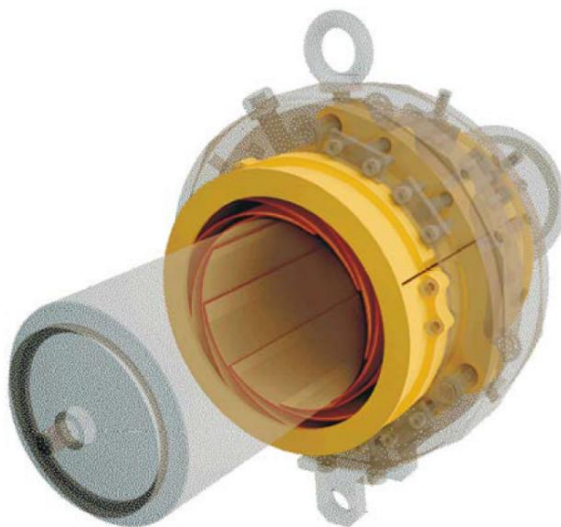
Рис. 2: Типичная структура газодинамического подшипника [3]
