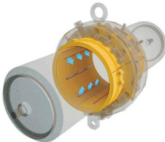
Рис. 1. Схема газостатических подшипников [3]
