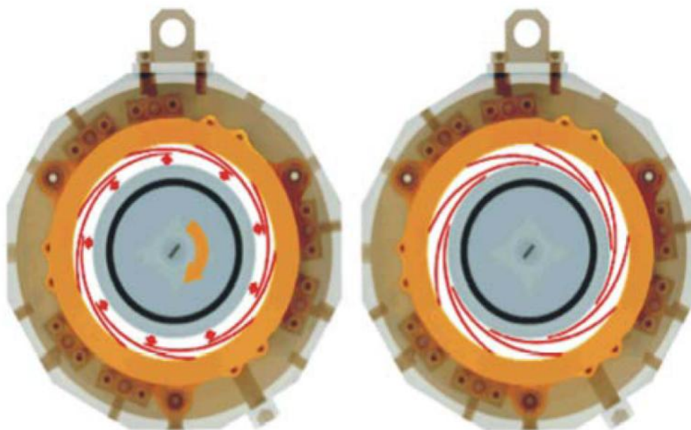
Рис. 3: Вал в газодинамическом подшипнике [3].
