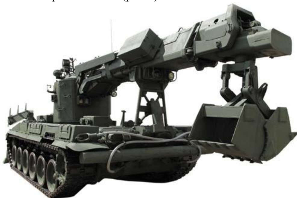
Рис.1. Инженерная машина ИМР-3М
