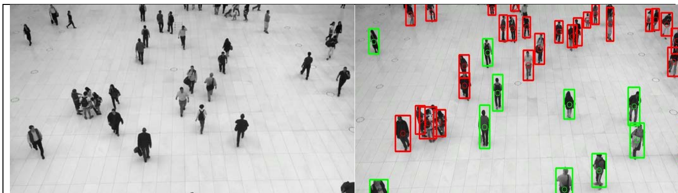
Рис. 2. Пример работы детектора физического дистанцирования: слева – необработанные данные; справа – прошедшие обработку детектором (в красной рамке объекты с нарушением дистанции)
