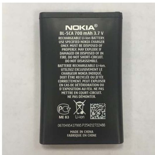
Рис. 2. Вздутый аккумулятор до прокола
