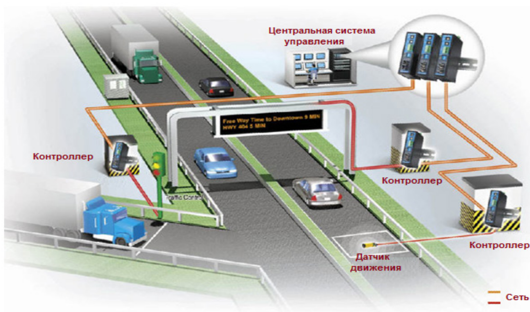
Рис. 1. Принцип работы системы «Умный светофор»
