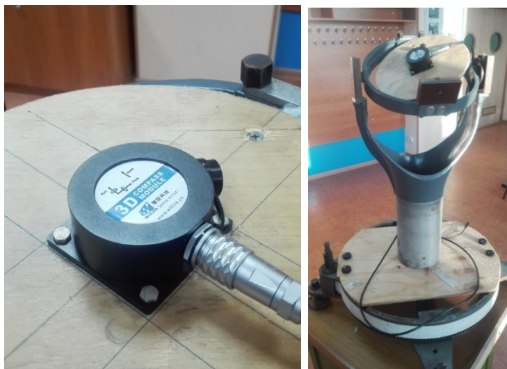
Рисунок 1 – Внешний вид цифрового магнитного компаса SEC385 и стенда для его испытания
