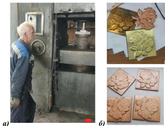
Рисунок 4 – Рабочая обстановка в процессе прессования на гидравлическом прессе (а) и рельефные оттиски на латунных, медных и деревянных образцах (б)
