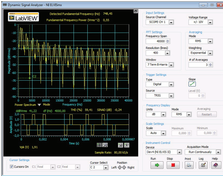
Рис. 13. Измерение частоты с нулевой амплитудой RZ-AMI
