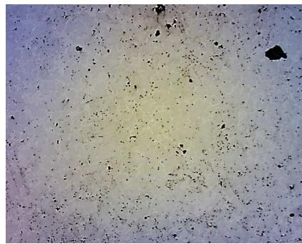
Рис. 1. Микроструктура сплавов Al-X (X-легирующие элементы) на оптическом микроскопе MICRO 200
