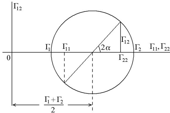
Рис. 1. Окружность Мора для поворота системы координат на угол  $\alpha$  вокруг оси  $OX_3$ .
