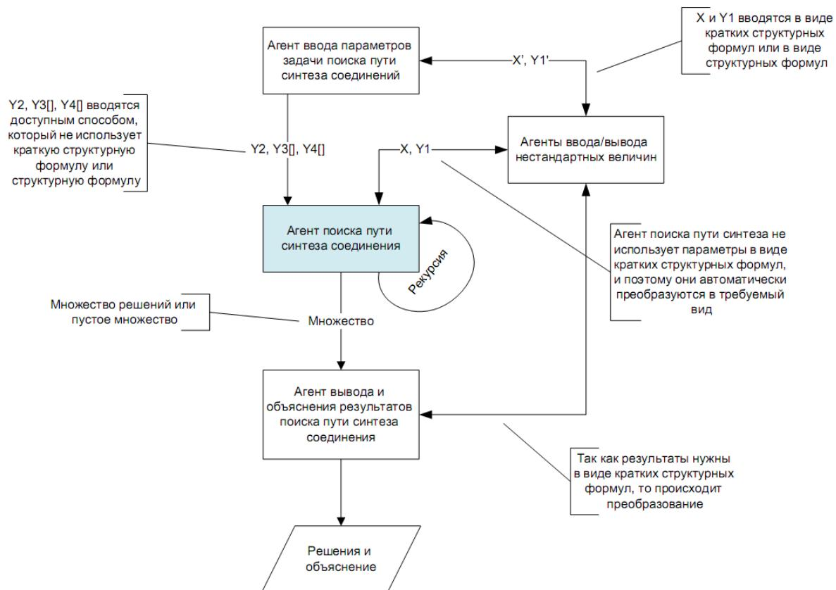
Рисунок 2 – Модель решателя класса задач поиска пути синтеза
