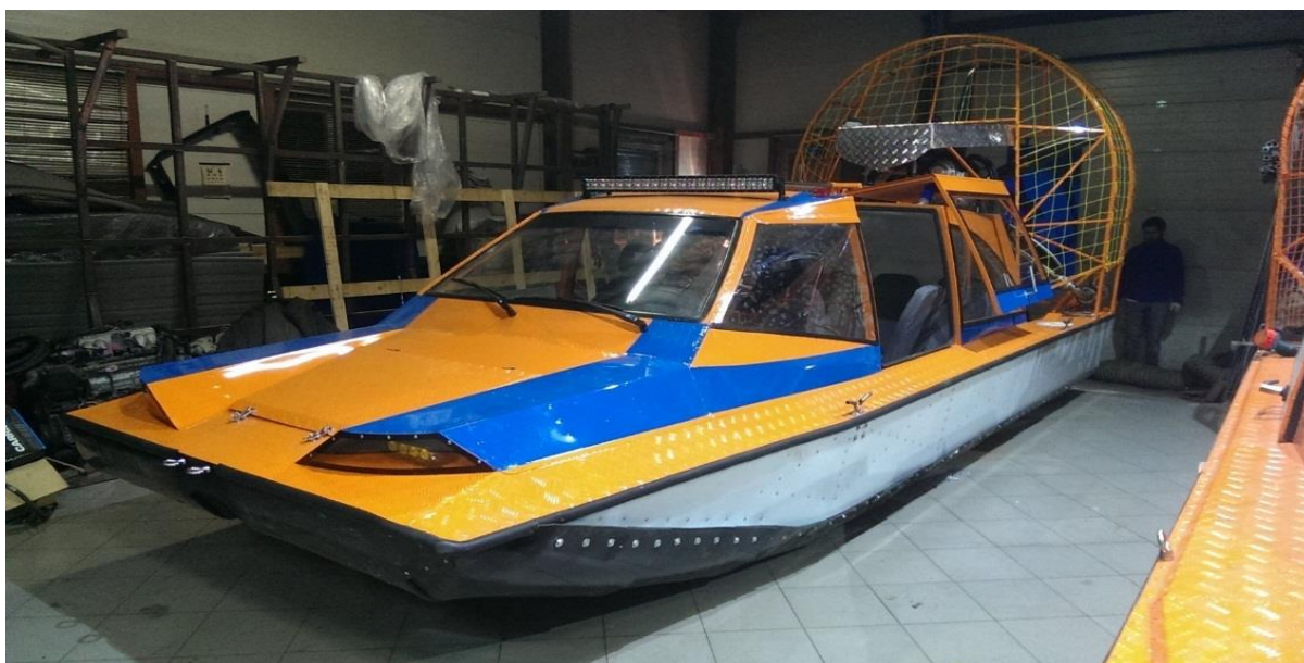
Рис.1. Аэролодка на 10 пассажиров.
