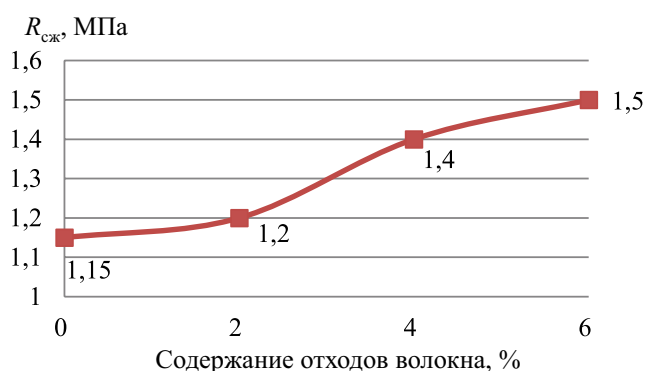
Рисунок 2. Зависимость прочности на сжатие от содержания ВБО
