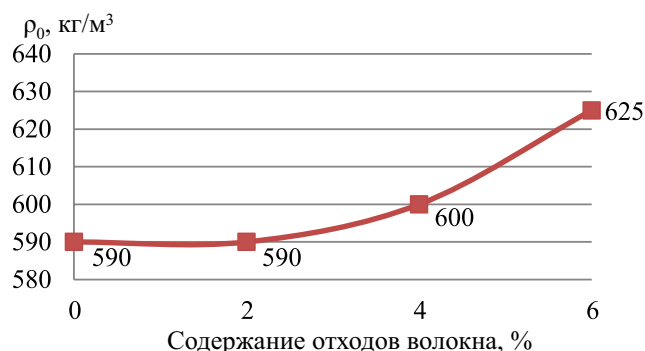
Рисунок 3. Зависимость средней плотности от содержания ВБО
